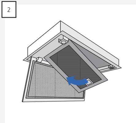
2 Tag filtret ud, ved at trække i filterets låsemekanisme, og derved løsne filtret fra emhætten.
