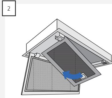
2 Poista suodatin vetämällä suodattimien lukitusmekanismia sen irrottamiseksi kuvusta.
