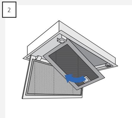
2 Ta ur fettfiltren genom att dra i filtrets låsmekanism, så att filtret lossas från flätkåpan.
