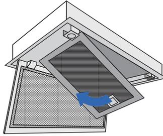
Ta ut filteret ved å trekke i filterets låsemekanisme, og løsne filteret fra viften.
