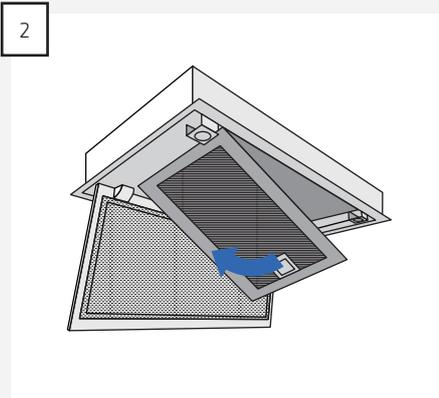
Tag filtret ud, ved at trække i filterets låsemekanisme, og derved løsne filtret fra emhætten.
